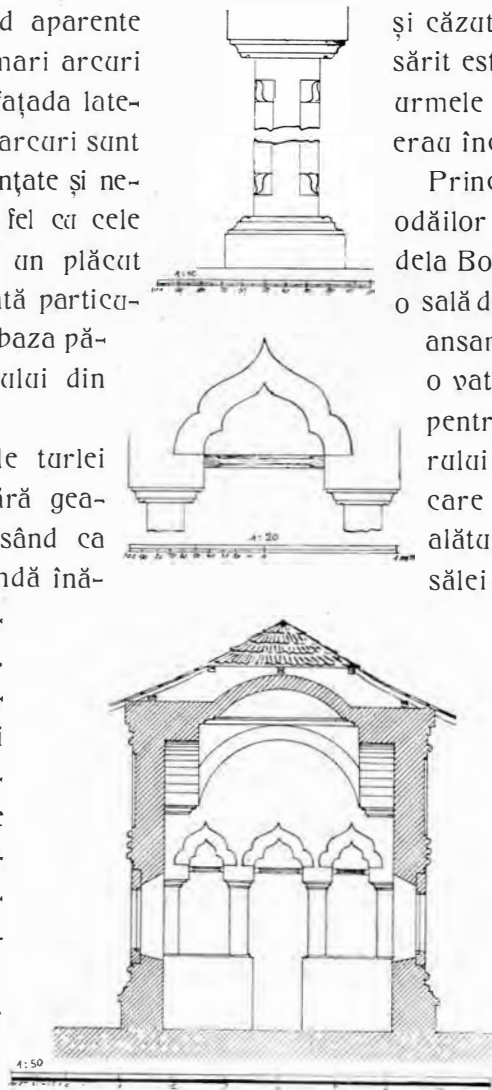
Biserica schitului Sf. Apostoli secție transversală prin pronaos și davali : arcade interioare și stâlp de pridvor.
